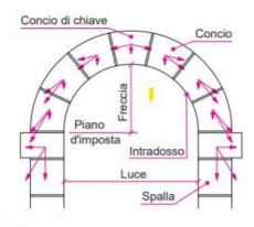
Lo schema, oltre alla nomenclatura degli elementi dell'arco, illustra l'andamento delle forze trasmesse da un concio a quello adiacente; il peso di ogni concio si compone alla forza che gli perviene da quello soprastante. Sul piano d'imposta gravano forze inclinate, scomponibili in una forza verticale, assorbita dalla spalla, e una orizzontale, contrastata dal muro o da altri archi
